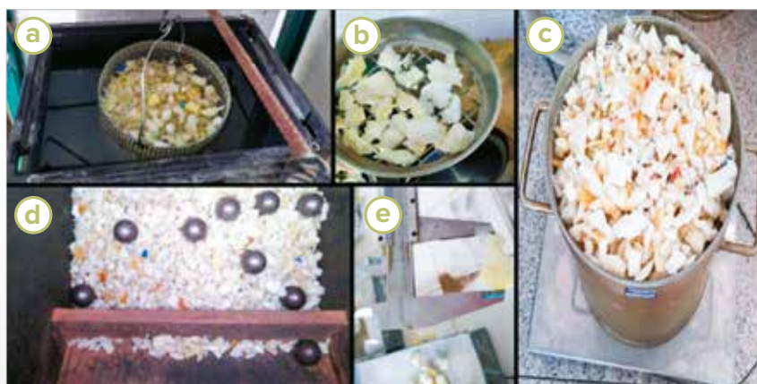
Figura 2 Ensaios de caracterização realizados no agregado reciclado, (a) densidade e absorção, (b) granulometria, (c) massa unitária e índice de vazios, (d) desgaste por abrasão e (e) índice de forma. Fonte: Os autores (2022)
